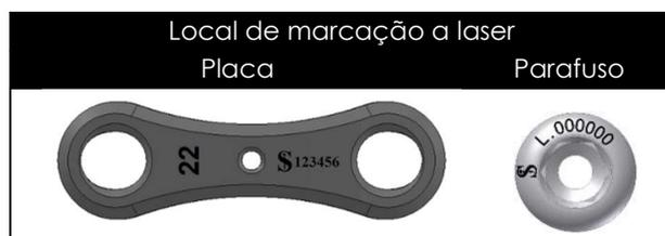
O local a ser efetuada a marcação dos produtos é eleito conforme descrito na norma ABNT NBR 12932 – Implantes para cirurgia - Materiais Metálicos - Preparação de superfície e marcação, e é efetuada em regiões de baixas concentrações de tensões onde não cruzam com escareados ou bordas dos implantes.
