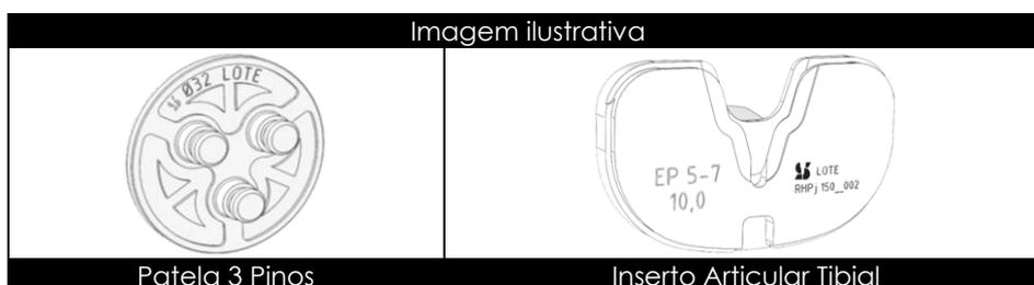
O Componente Femoral e Tibial recebe marcação a laser contendo o logotipo da empresa, lote, material e código. A marcação do tamanho no Componente Femoral é direta no fundido em alto relevo e no Componente Tibial é marcado a laser, como mostra a imagem ilustrativa a seguir:
