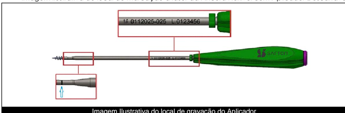
O local a ser efetuada a marcação do produto é eleito conforme descrito na norma ABNT NBR 12932 Implantes para cirurgia - Materiais Metálicos - Preparação de superfície e marcação, e é efetuado em regiões de baixas concentrações de tensões onde não cruzam com escareados ou bordas dos implantes.
