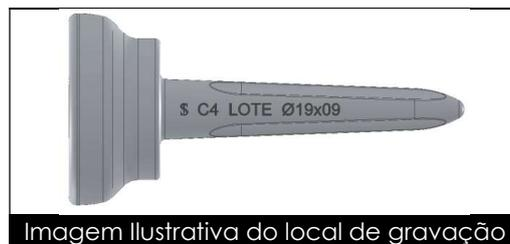
O local a ser efetuada a marcação do produto é eleito conforme descrito na norma ABNT NBR 12932 Implantes para cirurgia - Materiais Metálicos - Preparação de superfície e marcação, e é efetuada em regiões de baixas concentrações de tensões onde não cruzam com escareados ou bordas dos implantes.
